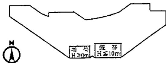
増築等をする建築物が規制対象建築物であれば、既存の建築物を含めた複合日影が規制の対象となる。
