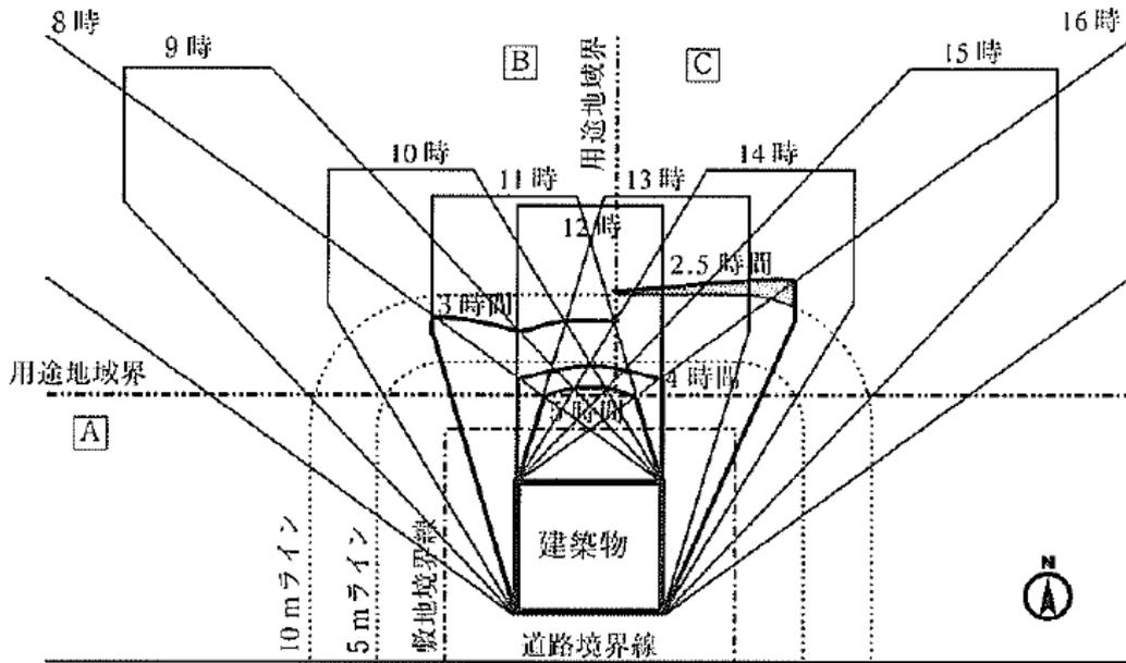
図の場合、□ A □ B □ C それぞれの区域の規制時間を下表のとおりとすると、□ C の区域で、
