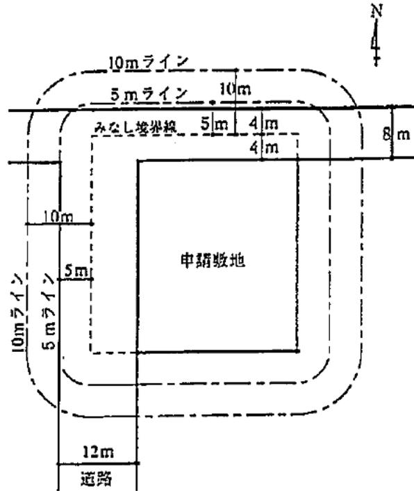
発散方向による緩和をした場合（発散法）
