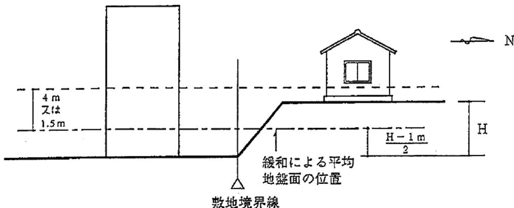
建築物の敷地の平均地盤面が「隣接又は接続する土地で日影の生ずるもの」の地盤面並びに地表面より1m以上低い場合の接続する範囲について
